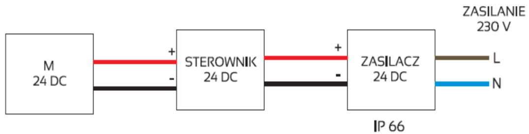
Fig.2 Schema di collegamento del motore
